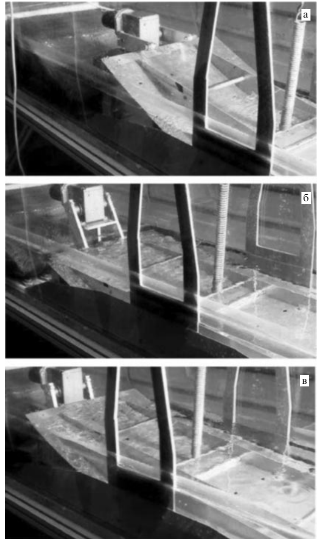
Рис. 6. Кинокадры, показывающие действие нажимного устройства волнового генератора: (а) нажимной кулачок, приводимый в действие мотором, приподнят над металлической пластиной; (б) момент нажатия кулачка, пружина растянута; (в) кулачок соскакивает с края пластины, пружина выдёргивает изогнутую пластину, весь объём воды выбрасывается вправо, к "берегу".
