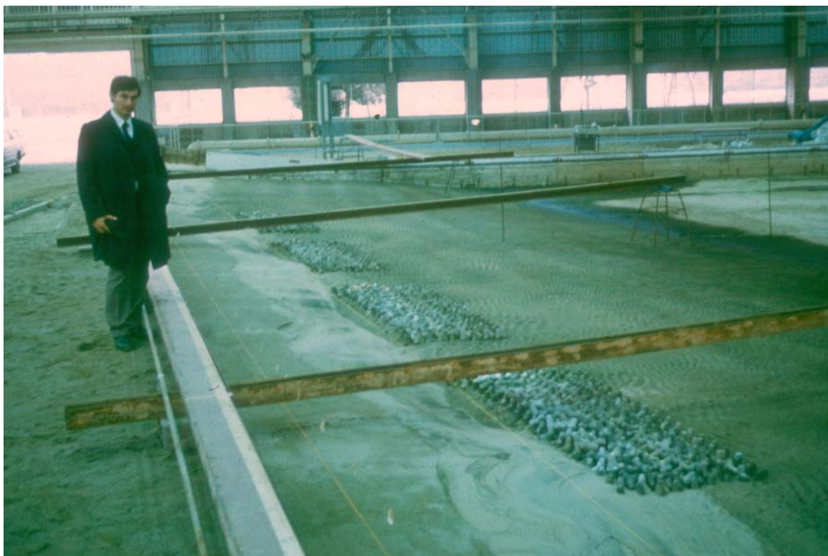
Рис. 1. Бассейн для экспериментального изучения морских волн.
