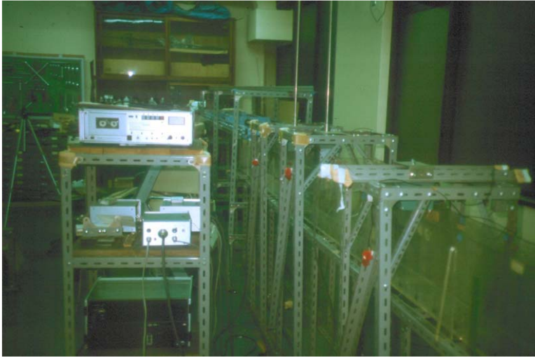
Рис.3. Фотография установки для изучения трансформации одномерных волн над неровностями дна
